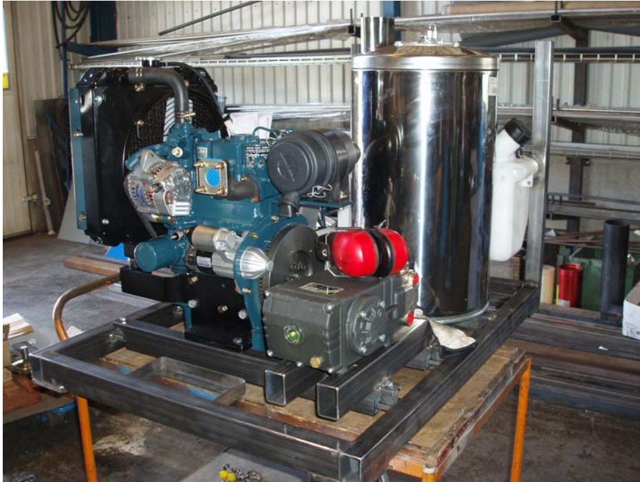
Under byggnation dieseldriven klottersanerare med värme. Maxtryck 200 bar Kapacitet 21 l/min Drivkälla Kubota 2 cylindrar in line
