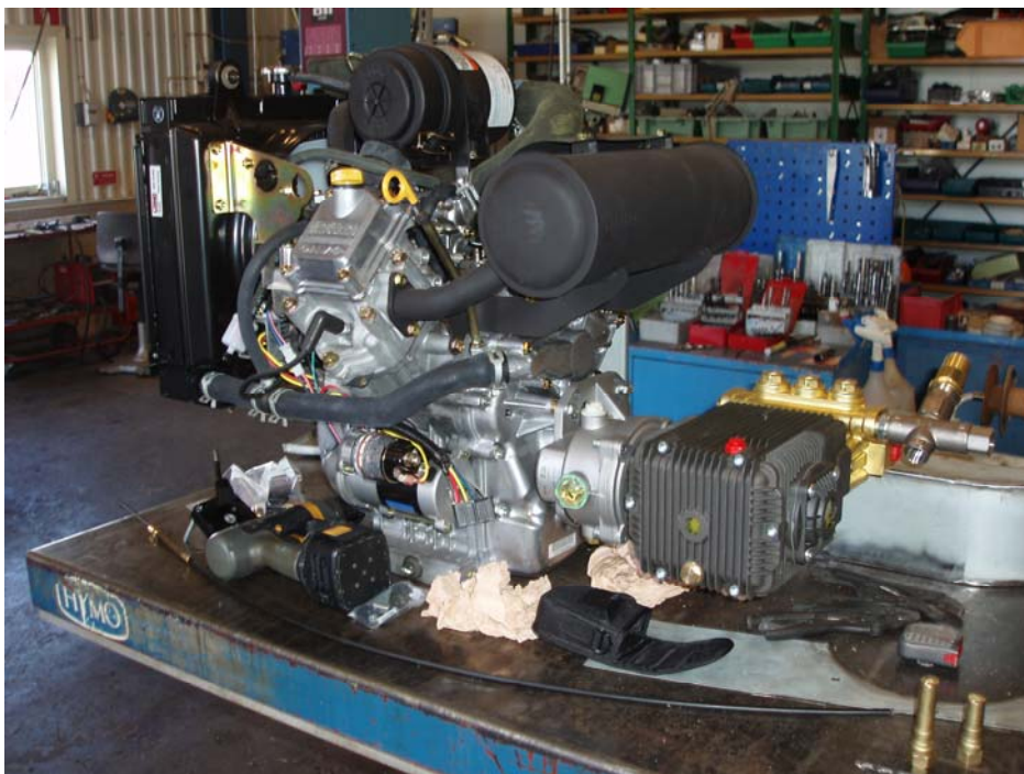
Under byggnation dieseldriven högtrycksspolare med värme. Maxtryck 500 bar Kapacitet 15 l/min Drivkälla Vanguard bensinmotor V tvin
